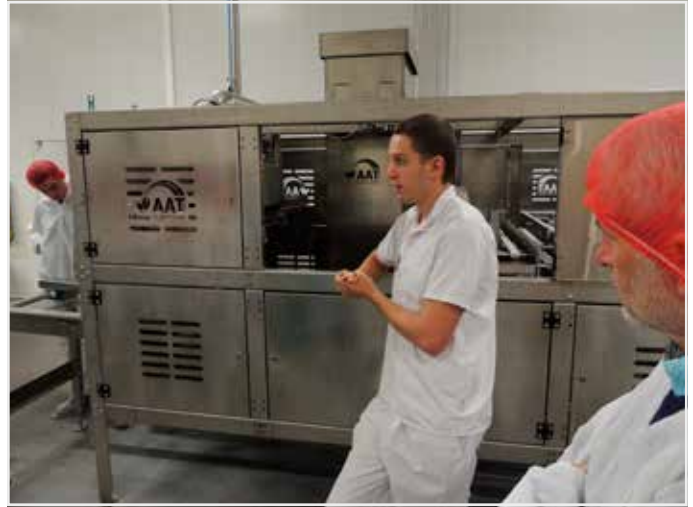
De in-ovogeslachtsbepaling vindt plaats op dag 13. Twee camera's nemen beeldopnames, waarna een computer de eieren onderverdeelt in 3 groepen: eieren met een vrouwelijk embryo, eieren met een mannelijk embryo en onbevruchte eieren.
