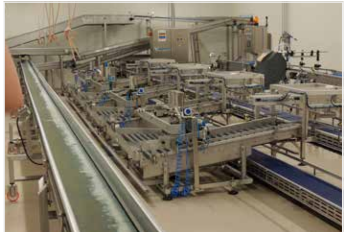
Met dit toestel worden de kuikens automatisch gevaccineerd in de nek.
