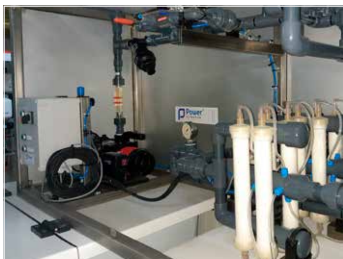
Foto 2: Regenwaterbehandeling op basis van nano-ultrafiltratie.
