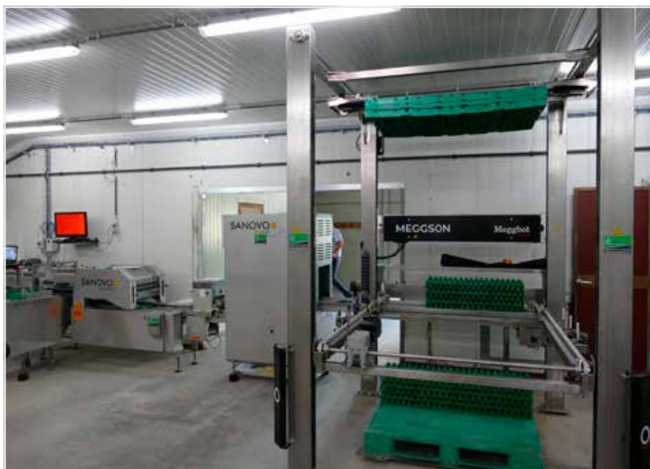
Het eierlokaal met de Staalkat farmpacker en de Meggbot TP100 palletiser
