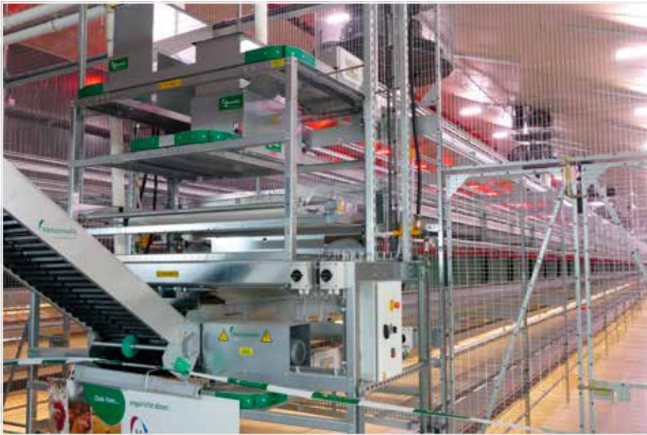
In de voliërestal zijn de kippen gehuisvest op drie rijen Bolegg Terrace systemen met mid-dennestbanden.
