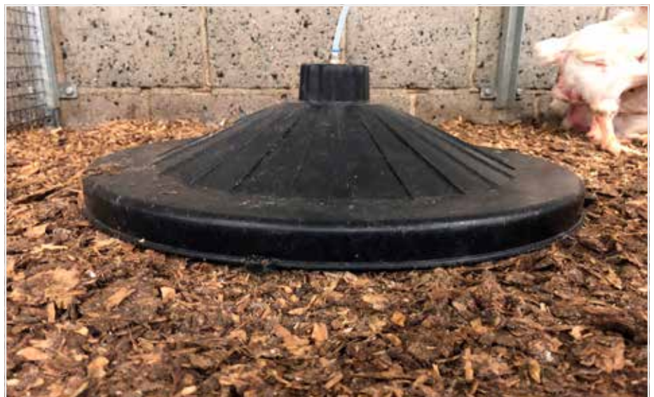
De NH 3 -concentraties werden op strooiselniveau gemeten met behulp van dit soort deksels op 3 plaatsen per hok.
