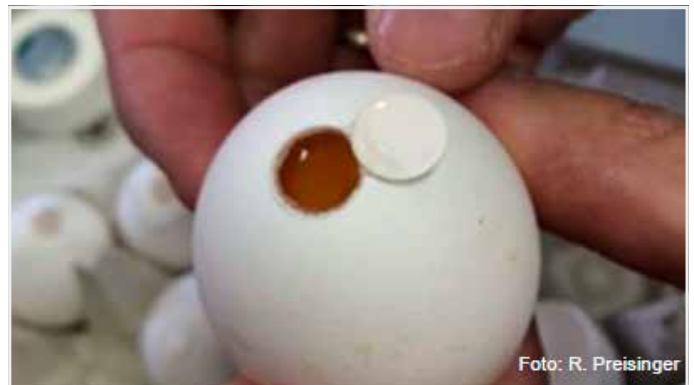
Bij de RAMAN-spectroscopie-technologie moet een gat in de eischaal gemaakt worden met een diameter van 12 mm groot (foto prof. Preisinger).
