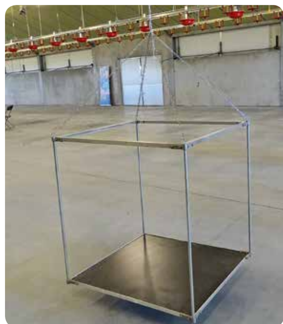
Het gewicht van de kalkoenen wordt nauwgezet opgevolgd via een automatisch weegstelsel.
