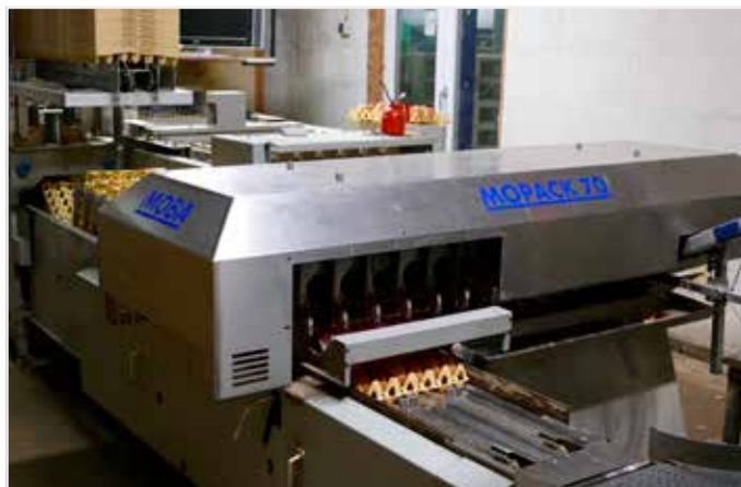
In het eierlokaal staat een Mopack 70 in voor de eierbehandeling.
