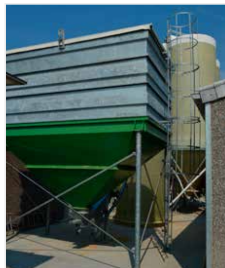
Een tarwebak is voor de voedersilo's geplaatst om vlot de eigen tarwe te kunnen inmengen.
